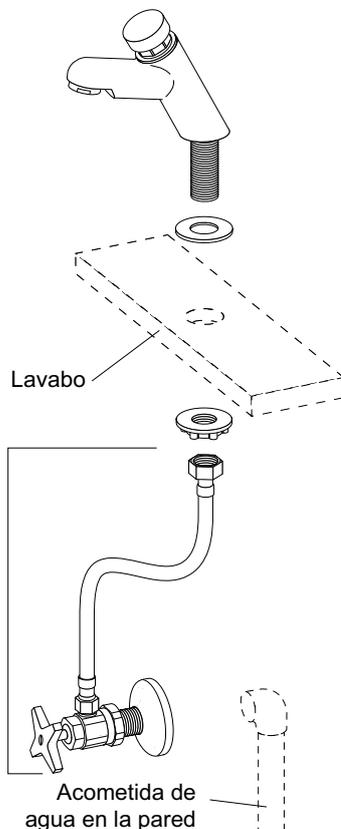
Para la conexión a la acometida de agua se recomienda el uso de una llave angular F.V.
