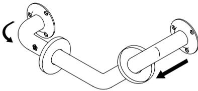
D- Fije el barral de apoyo en la pared mediante los tacos plásticos y tornillos provistos con el juego.
