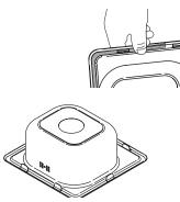
4. Oriente los ganchos de las llaves de anclaje hacia el mesón (D) e inserte las llaves de anclaje en las perforaciones del borde del fregadero (E). Gire los ganchos instalados para permitir la ubicación del fregadero en la perforación del mesón (F).
