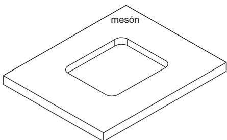
3. Limpie el borde de la perforación del mesón y el filo del fregadero. Coloque un cordón de silicona en el borde del fregadero e instale el fregadero por debajo del mesón, haciendo que el pozo del fregadero coincida con la perforación del mesón.
