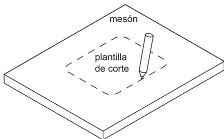
2. Retire la plantilla y perforo el mesón usando una herramienta adecuada para su tipo de mesón.
