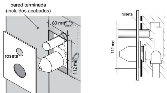
Para instalar correctamente la roseta, se debe dejar al rededor del protector plástico una perforación cuadrada de 80 por 112 milímetros únicamente en el acabado (las baldosas) como indica el gráfico, esto permitirá una correcta ubicación del porta o ring de la roseta a la pared.
