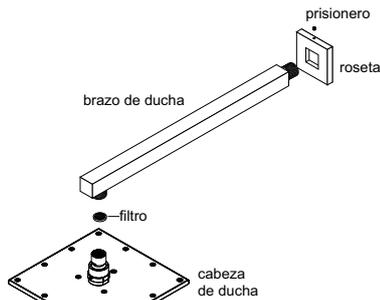
2. Inserte la roseta al brazo de ducha y coloque sellante (en el sentido de giro indicado) únicamente en la rosca del brazo de ducha e instálelo a la acometida de agua de la pared
