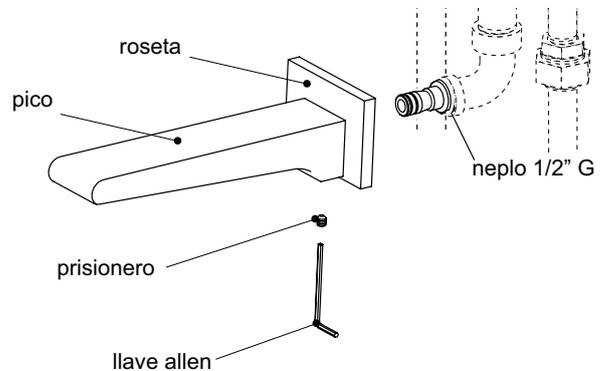
3. Realice una prueba para verificar que no existan fugas, de existir éstas, debe desarmar el conjunto y poner más sellante en las uniones.
