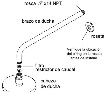
2. Inserte la roseta al brazo de ducha y coloque sellante (en el sentido de giro indicado) únicamente en la rosca del brazo de ducha e instálelo a la acometida
