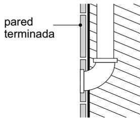
2- Ubique la roseta y el pico para lavabo, de la manera indicada en el gráfico. Utilice un sellante apropiado en la rosca del pico y ajústelo manualmente en la toma central de la mezcladora.
