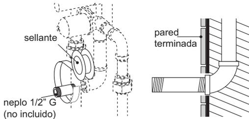
1- Con la pared terminada, ubique un niple 1/2" G (no incluido) el cual debe sobresalir de la pared lo suficiente para que el pico se instalen correctamente.
