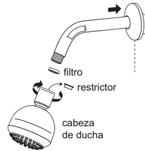
**NOTA:** Si debido a que existe baja presión en la red domiciliaria, el caudal de agua que sale por la ducha es muy bajo y no es el adecuado para bañarse; para aumentarlo retire el restrictor de la cabeza de ducha y vuelva a colocar el filtro para la retención de impurezas.
