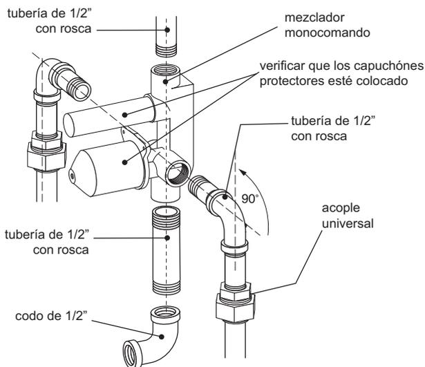
Para las uniones entre el mezclador y la tubería utilizar un sellante apropiado para evitar fugas.
