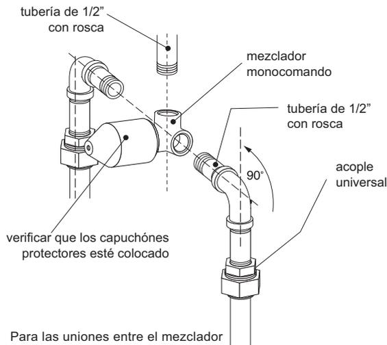
Para las uniones entre el mezclador y la tubería utilizar un sellante apropiado para evitar fugas.
