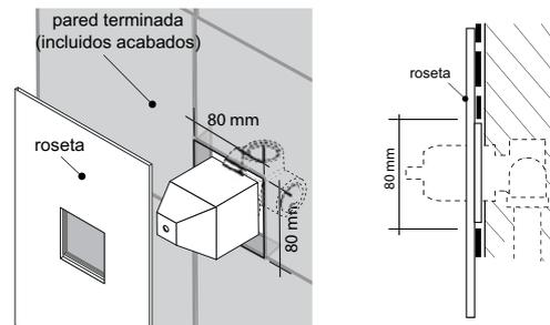
Para instalar correctamente la roseta, se debe dejar al rededor del protector plástico una perforación cuadrada de 80 por 80 milímetros unicamente en el acabado (las baldosas) como indica el gráfico, esto permitirá una correcta ubicación del porta o'ring de la roseta a la pared.
