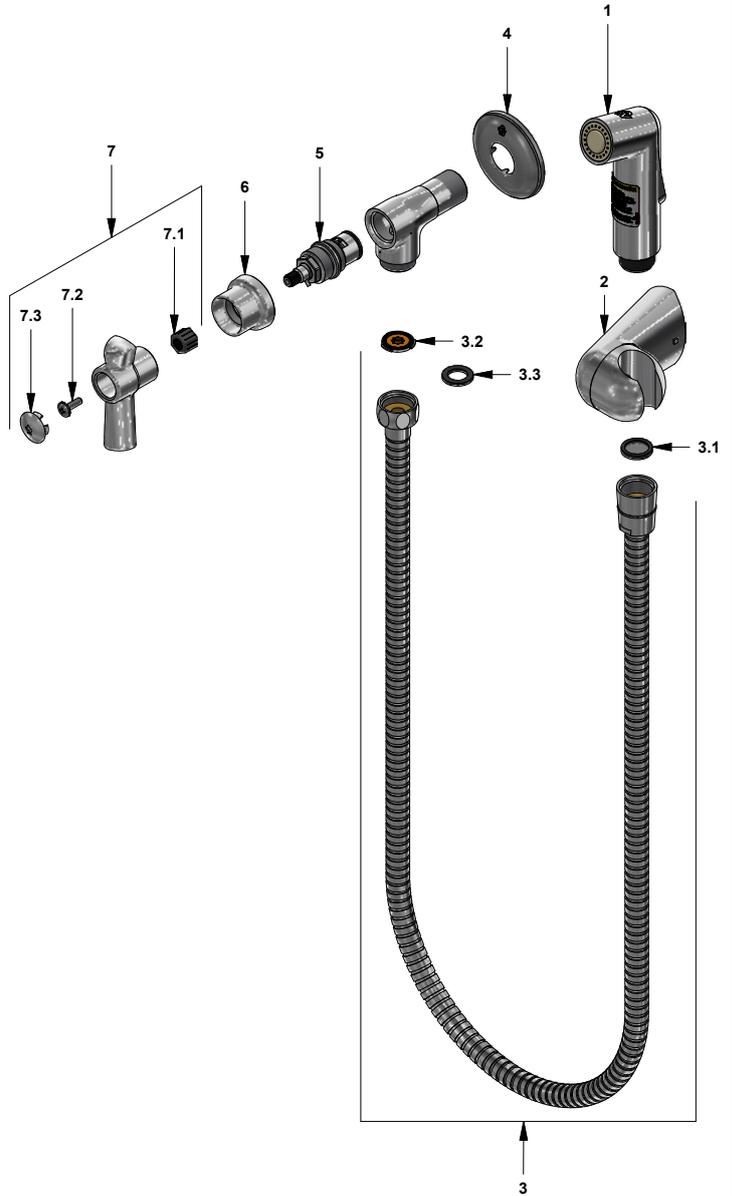
**Nota:** Si debido a que existe baja presión en la red domiciliaria, el caudal de agua que sale por la ducha es muy bajo y no es el adecuado para bañarse; para aumentarlo reemplace el restrictor de caudal (**3.2**) por el empaque de caucho (**3.3**).
