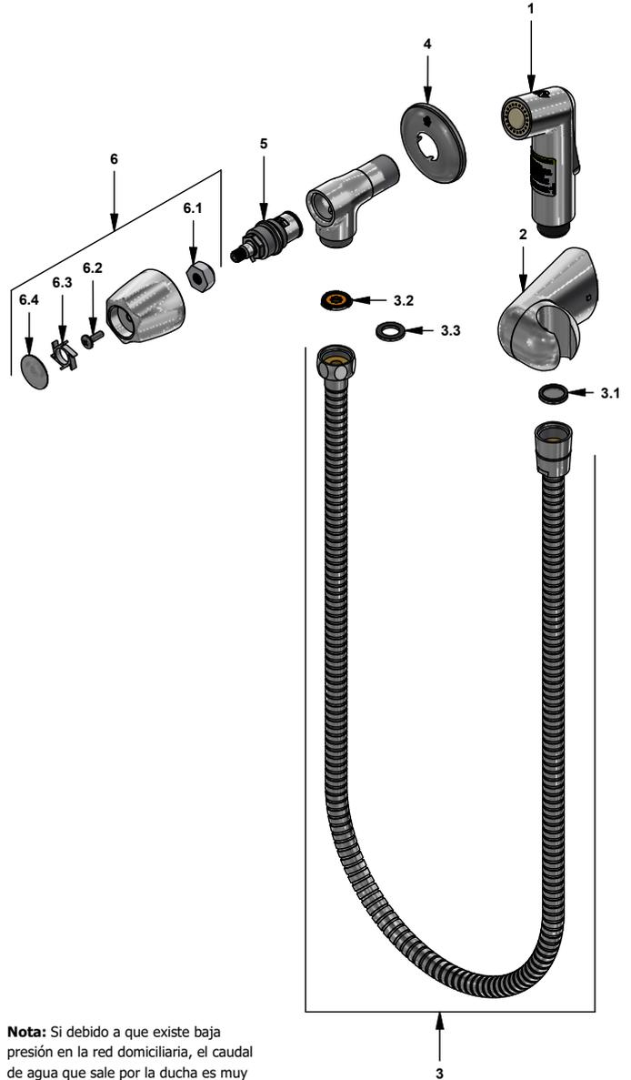
**Nota:** Si debido a que existe baja presión en la red domiciliaria, el caudal de agua que sale por la ducha es muy bajo y no es el adecuado para bañarse; para aumentarlo reemplace el restrictor de caudal (3.2) por el empaque de caucho (3.3).
