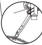
5- Conecte la cadena al botón superior de accionamiento. La cadena no debe quedar muy tensa ni flojo /
