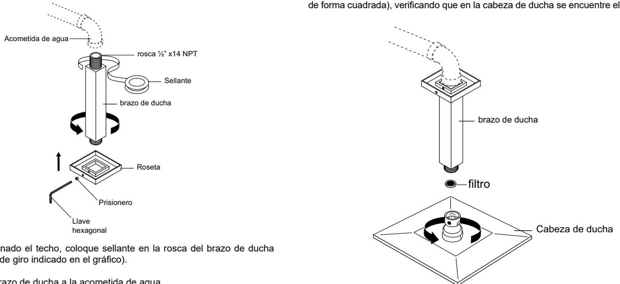
1- Una vez terminado el techo, coloque sellante en la rosca del brazo de ducha (en el sentido de giro indicado en el gráfico).
