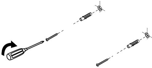
D- Inserte el respaldo en los tornillos sobresalidos y ubíquelo en la posición final, luego ajuste los tornillos.
