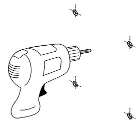
C- Ajuste los tornillos dejando una distancia de 5 mm sin llegar hasta el tope de la pared, para anclar el dispensador de toallas posteriormente.
