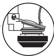
Conecte las válvulas (de ingreso y descarga) con la manguera "M". / Connect both valves (entry and discharge) with the hose "M".
