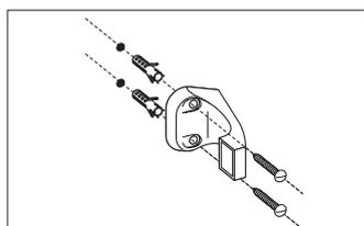
3. Fije el accesorio en la pared mediante los tacos plásticos y los tornillos.
