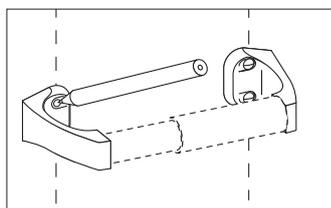
4. Repita el procedimiento para instalar el segundo soporte.
