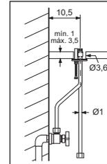
Para realizar la conexión de la grifería a las acometidas de agua de la pared, utilice llaves angulares para mangueras flexibles FV (No incluidas).
