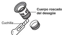
3. Viene con agujeros Pre-definidos. Se deben realizar los cortes para usar en lavabos con rebosadero. **NO se debe cortar si el lavabo no tiene rebosadero.**
