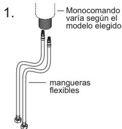
2- Si el monocomando tiene roseta. Coloque la roseta con el o'ring en la base del monocomando, de lo contrario coloque el o'ring en la base.
