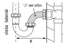
4- Con el desagüe y el acople armados ajuste manualmente las tuercas, para realizar un perfecto sellado. Realice una prueba y verifique que no existan fugas.
