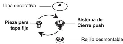
El conjunto se puede retirar, para fácil limpieza y mantenimiento.
