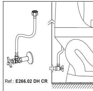
**Nota:** el exceso de ajuste de la tuerca B puede causar la ruptura de la válvula de ingreso A.
