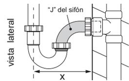
4- Con el desagüe y el acople armados ajuste manualmente las tuercas, para realizar un perfecto sellado. Realice una prueba y verifique que no existan fugas.
