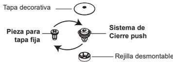
2. Para la instalación en lavabos Slim, corte en la segunda marca el cuerpo roscado del desagüe. **No es necesario cortar el cuerpo roscado del desagüe para usar con otros diseños de lavabos.**
