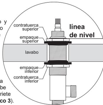
Ajuste la llave lateral con la contratuerca inferior hasta que quede fija en el lavabo (para el ajuste se debe utilizar una herramienta apropiada). No la apriete excesivamente pues puede quebrar el lavabo (gráfico 3).
