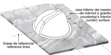
B5- Cuidadosamente voltear el mesón de mármol, granito o madera, colocarlo en su ubicación final e instalar la grifería FV de su elección.
