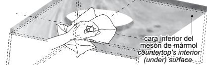
B3- Aplicar el adhesivo de silicona en todo el contorno del lavabo, colocarlo sobre el mesón de mármol o granito en la posición final donde será instalado y mantenerlo presionado durante un minuto.
