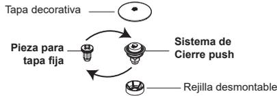
El conjunto se puede retirar, para fácil limpieza y mantenimiento.
