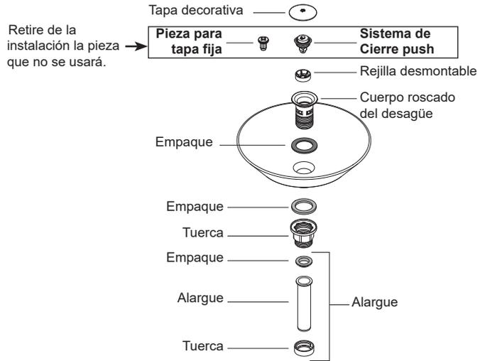
**Nota:** el alargue del desagüe es compatible con sifones metálicos y/o plásticos.
