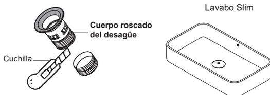
3. Viene con agujeros **Pre-definidos**. Se deben realizar los cortes para usar en lavabos con rebosadero. **NO se debe cortar si el lavabo no tiene rebosadero.**
