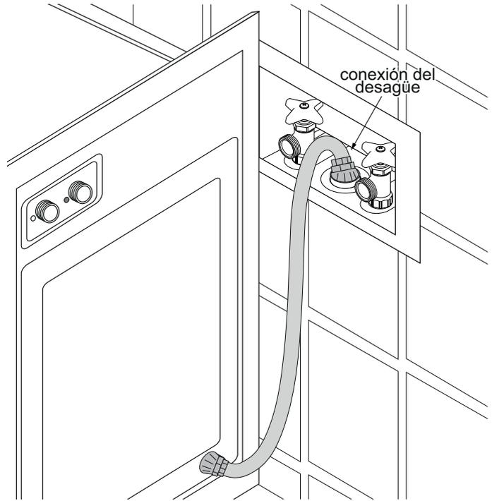
7. Conecte las mangueras de la lavadora a las salidas de agua de las llaves instaladas.
