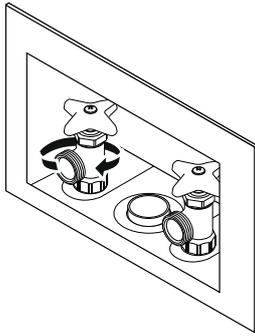
5. Cubra la caja plástica y las llaves ya instaladas para evitar que se dañe y coloque el recubrimiento de la pared (cerámica).
