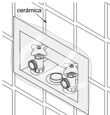
6. Instale la manguera del desagüe de la lavadora a la conexión del desagüe de caja plástica.
