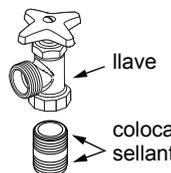
Si la conexión de rosca es macho, retire el nepló de prolongación e instale como indica el gráfico.
