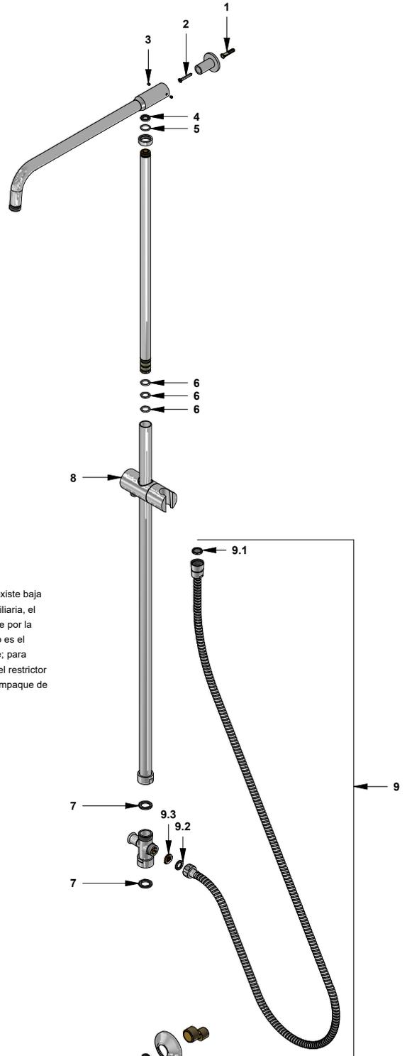
Nota: Si debido a que existe baja presión en la red domiciliaria, el caudal de agua que sale por la ducha es muy bajo y no es el adecuado para bañarse; para aumentarlo reemplace el restrictor de caudal (9.3) por el empaque de caucho (9.2).
