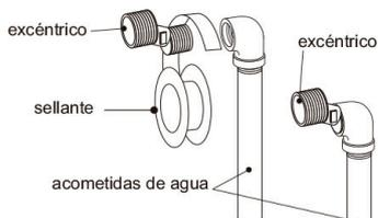
3- Enrosque las rosetas a los excéntricos hasta que lleguen a la pared, luego atornille ligeramente las tuercas del monocomando a las conexiones excéntricas, colocando los empaques de caucho, como indica el gráfico. Verifique la horizontalidad del monocomando y proceda a ajustar.
