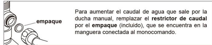
Para aumentar el caudal de agua que sale por la ducha manual, reemplazar el **restrictor de caudal** por el **empaque** (incluido), que se encuentra en la manguera conectada al monocomando.
