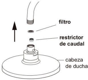
2- Ajuste el extremo cónico de la manguera a la ducha manual (no incluida) y el otro extremo al monocomando, verificando que se encuentren colocado el restrictor de caudal y el filtro en los sitios que indican los gráficos.
