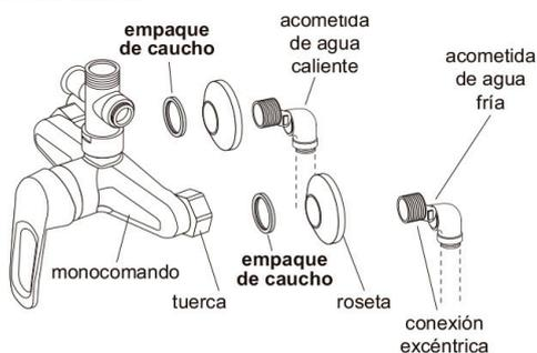
4- Instale provisionalmente el tubo para ducha con la extensión tubo ducha y el brazo de ducha al monocomando y ubique el soporte a la altura deseada. Marque en la pared donde realizará la perforación para el soporte, verificando la verticalidad de los tubos de ducha, ver gráfico A.
