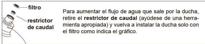
Para aumentar el flujo de agua que sale por la ducha, retire el **restrictor de caudal** (ayúdese de una herramienta apropiada) y vuelva a instalar la ducha solo con el filtro como indica el gráfico.
