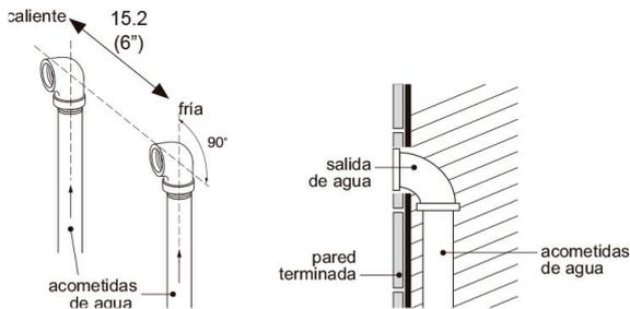
2- Con la pared terminada coloque el sellante adecuado en los extremos de 1/2" de las conexiones excéntricas y ajuste a las acometidas de agua.
