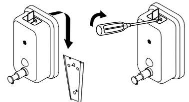
B- Desmonte la placa de anclaje del dispensador, ubique el lugar donde se realizarán los agujeros para la fijación. Verifique los niveles: horizontal y vertical y marque.
