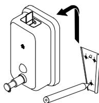
D- Fije la placa de anclaje en la pared mediante los tacos plásticos y tornillos provistos con el juego.
