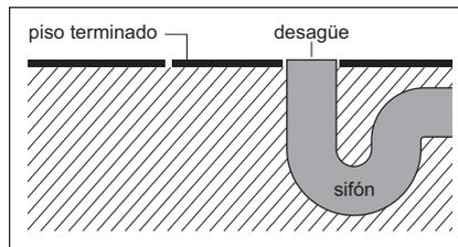
Antes de instalar la tina en el sitio elegido, para evitar que salgan malos olores de la cañería, asegúrese que el desagüe que está en el piso de su baño tenga instalado un sifón.
