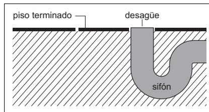
Antes de instalar la tina en el sitio elegido, para evitar que salgan malos olores de la cañería, asegúrese que el desagüe que está en el piso de su baño tenga instalado un sifón.
