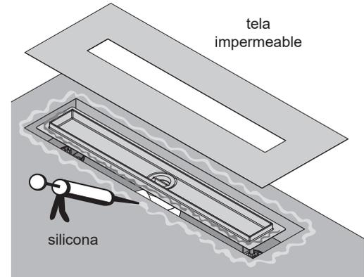
2. Coloque la base de la rejilla regulando la altura de los soportes cuidando que queden nivelados horizontalmente instale el conjunto al desagüe del piso ajustando la tuerca superior con la herramienta incluida, verifique la ubicación de los empaques **Figura 2**.
