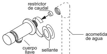
2. Verifique la altura y distancia horizontal del urinario con respecto a la llave instalada. Con cuidado doble el tubo de conexión y corte si es necesario para una correcta instalación.
