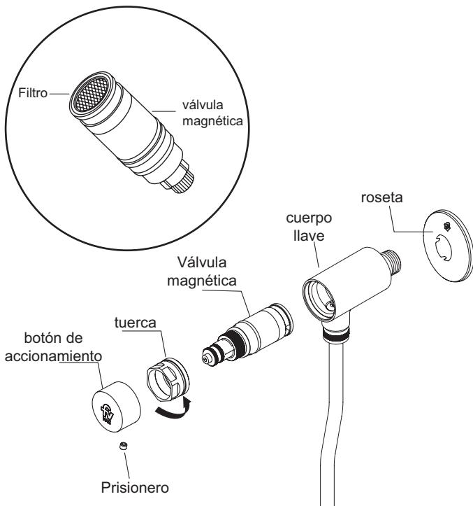
**AVISO IMPORTANTE:** Al conectar el suministro de agua (por instalación, mantenimiento o restablecimiento de la red por corte de suministro), se genera un flujo automático. En este caso, accione el botón 5 veces consecutivas para iniciar el mecanismo interno de la válvula y espere a que cierre el flujo de agua.
