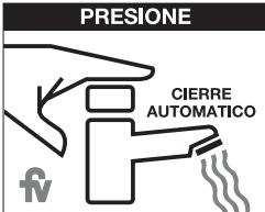
Dentro del embalaje se encuentra un adhesivo con las instrucciones del funcionamiento de las llaves y válvulas. **Coloque en un azulejo próximo al botón de accionamiento.**
