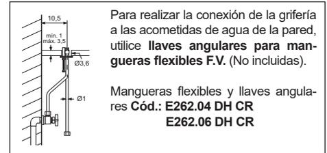
Para realizar la conexión de la grifería a las acometidas de agua de la pared, utilice **llaves angulares para mangueras flexibles F.V.** (No incluidas).
