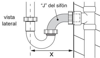
3- Con el desagüe y el acople armados ajuste manualmente las tuercas, para realizar un perfecto sellado. Realice una prueba y verifique que no existan fugas.
