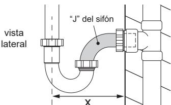
3- Con el desagüe y el acople armados ajuste manualmente las tuercas, para realizar un perfecto sellado. Realice una prueba y verifique que no existan fugas.
