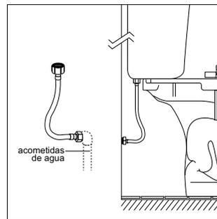
**Nota:** el exceso de ajuste de la tuerca **B** puede causar la ruptura de la válvula de ingreso **A**.
