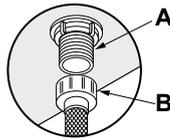
1. Parala mangera flexible cód. **E275.02.03** Conecte un extremo de la mangera flexible a la acometida de agua de la pared usando sellante en la rosca en sentido de giro indicado y el otro extremo a la válvula de ingreso del inodoro. No necesita sellante.
